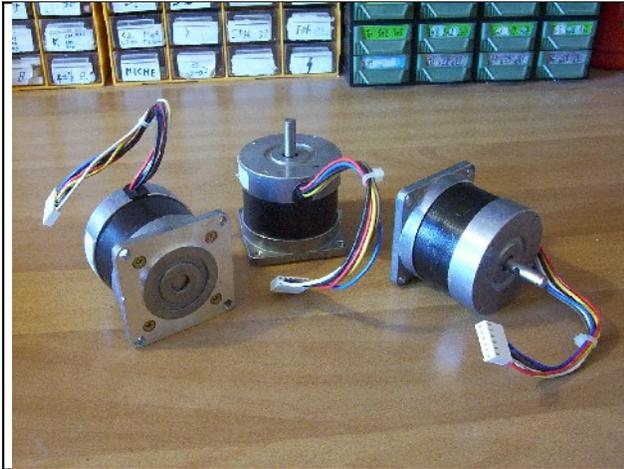
Chaque moteur se relie à son propre connecteur 6 broches. Il n'y a pas de détrompeur sur les connecteurs moteur. Si vous branchez le moteur à l'envers celui-ci ne tournera pas, mais se subira aucun dommage. La sérigraphie à côté des connecteurs (« WhBkBrYlRdB l ») vous aide à connecter les moteurs de manière correcte.
