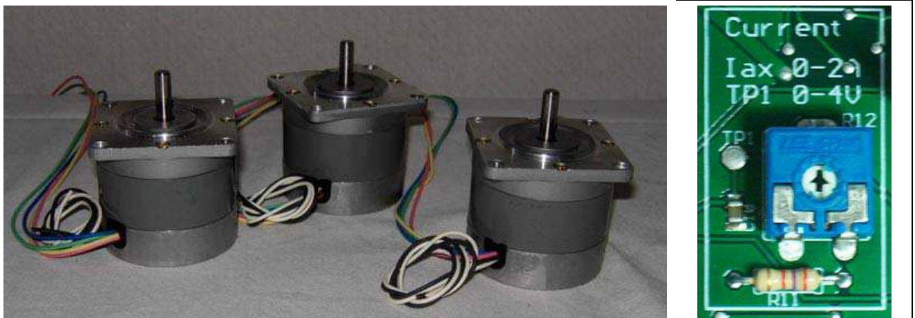
Moteur à 6 fils 0,8 Nm / 1,3 A, recommandé par Cobra, et son réglage de courant à 1,0 A
